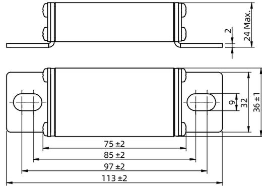
安装方式: BK (刀型连接)
